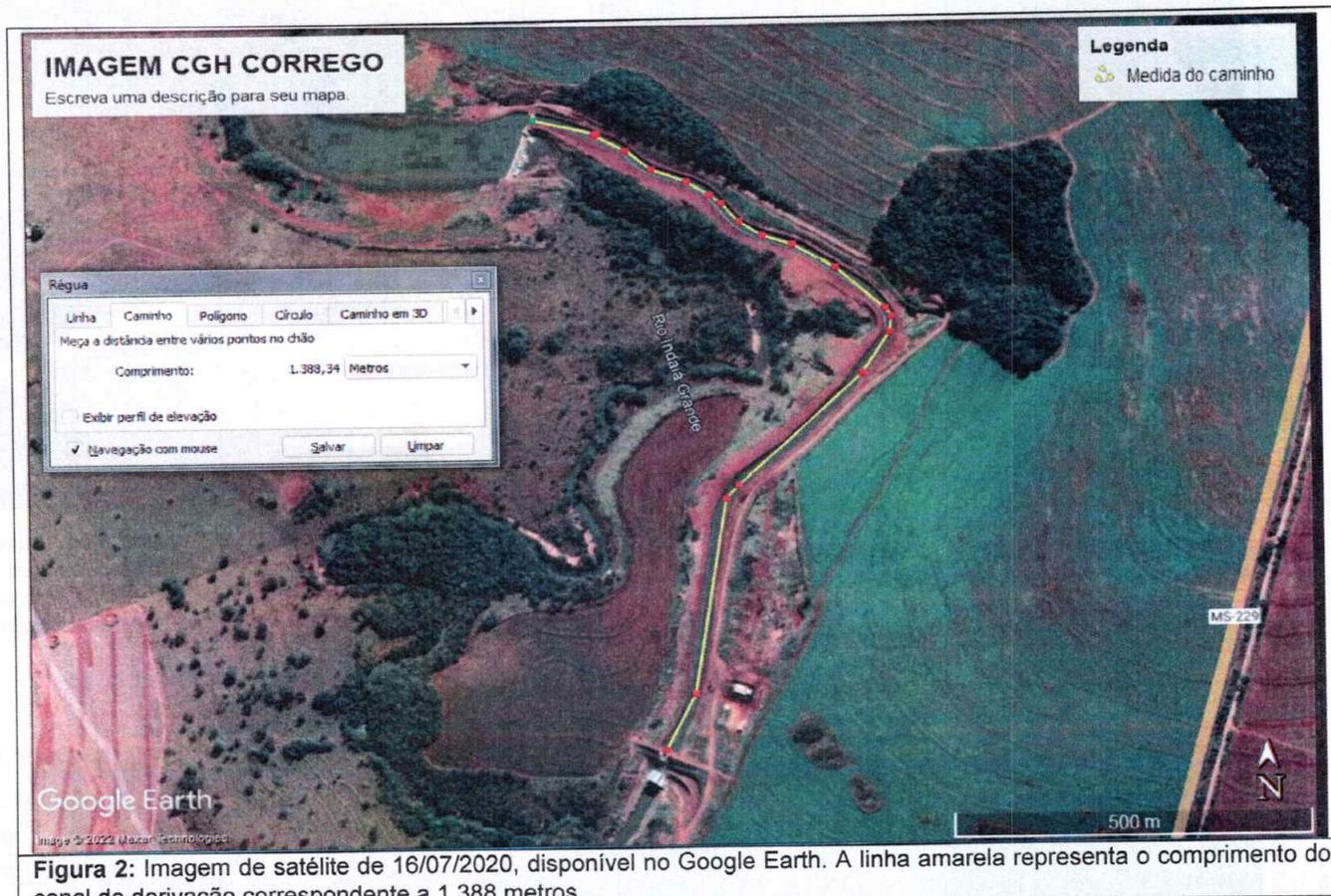
**Figura 2:** Imagem de satélite de 16/07/2020, disponível no Google Earth. A linha amarela representa o comprimento do canal de derivação correspondente a 1.388 metros.
